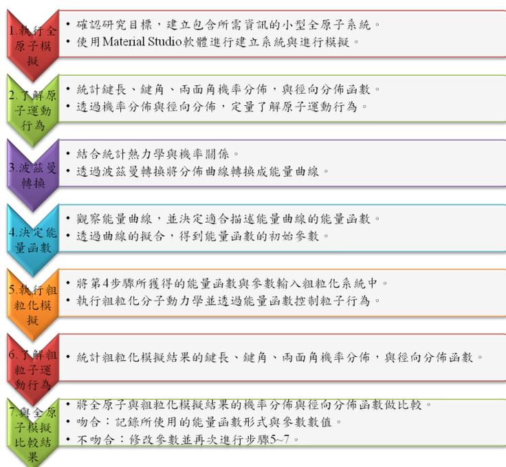
粗粒化分子動力學與全原子分子動力學擬合流程示意圖。
